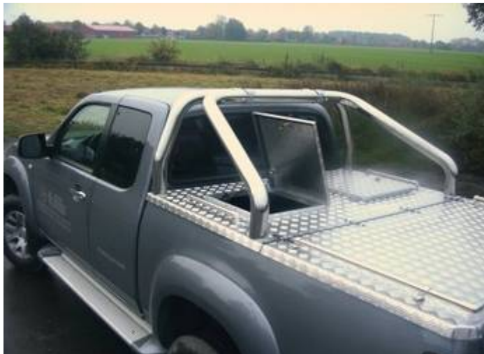
Mazda BT50 mit 2-teiliger Ladeflächenklappe, 22er Reling, zusätzlichen Stauklappen und Überrollbügel
